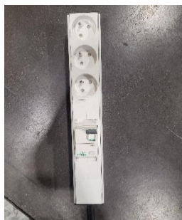
Boîtier 16A (3.5kw) avec 3 sorties en « prise ménagère » les 16A sont réparties sur les 3 prises attention il n'y a pas 16A par prise.
